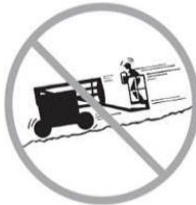
Limite a velocidade de movimentação de acordo com as condições da superfície do solo, congestionamentos, inclinações, localização do pessoal e quaisquer outros fatores que possam causar colisão.
