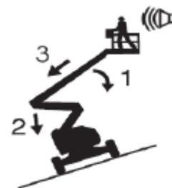
Se o alarme de inclinação soar com a plataforma em descida, proceda da seguinte forma:
