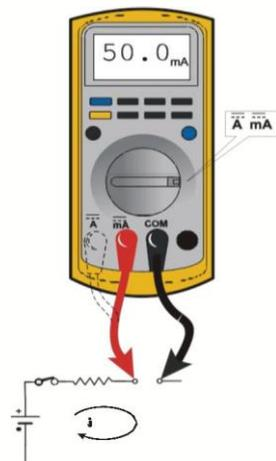
Figura 7-4 Medição da corrente (corrente direta)
