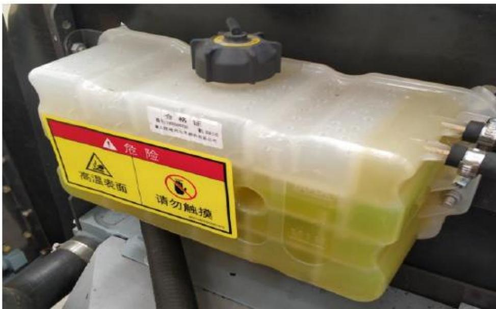
Ponto(s) de manutenção – Adicione/substitua a solução anti-congelamento
